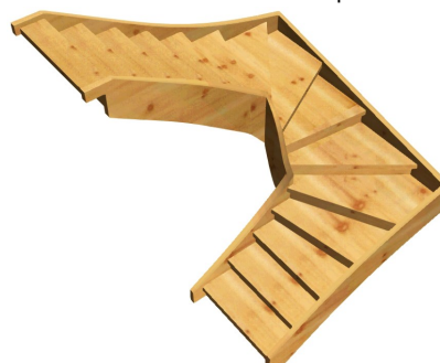
vista de zanca de una escalera tipo cuarto caracol
